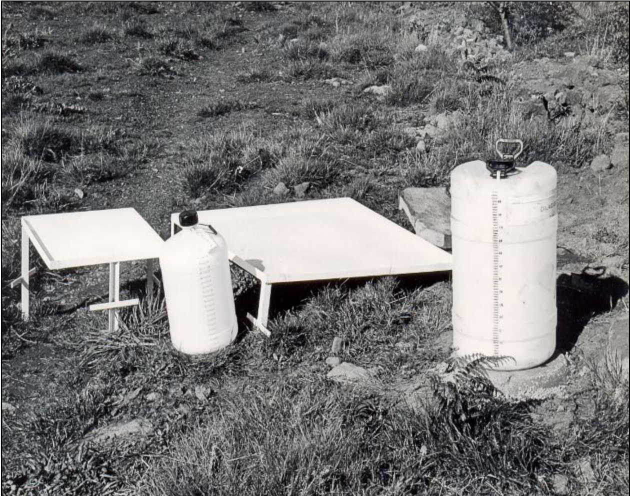
Mesas pluviométricas de 50*50 cm 2 y 100*100 cm 2 diseñada en ICONA para medir la precipitación en el interior del arbolado. Los depósitos están aforados.
