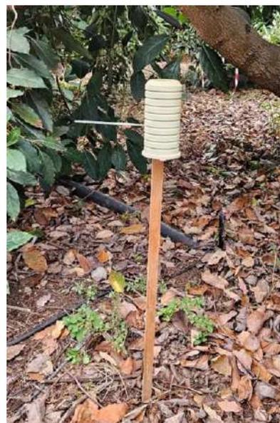
Figura 16. Registrador de temperatura y humedad en carcasa protectora.
