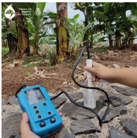
Figura 8. Medición de pH y conductividad eléctrica en campo
