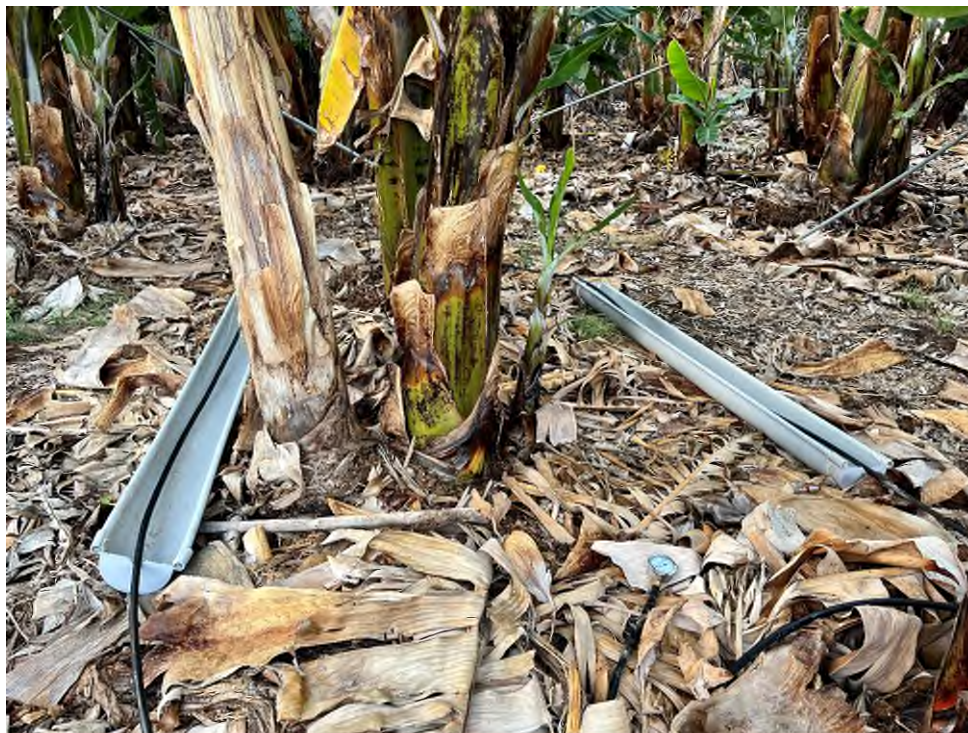
Figura 11. Método de recogida de volúmenes para el cálculo del coeficiente de uniformidad
