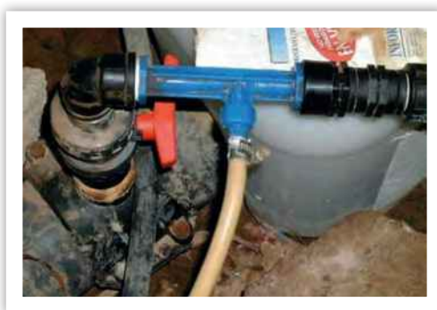
Equipos de inyección para aplicación de fitosanitarios en el riego localizado (Venturi a la izquierda, bomba de membrana a la derecha)
