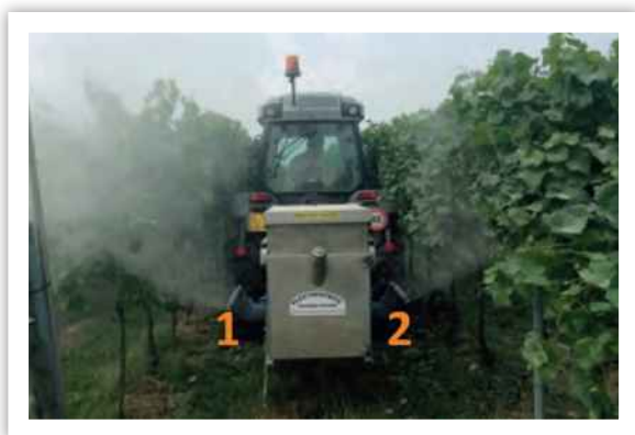
Espolvoreador suspendido a tractor con dos deflectores
