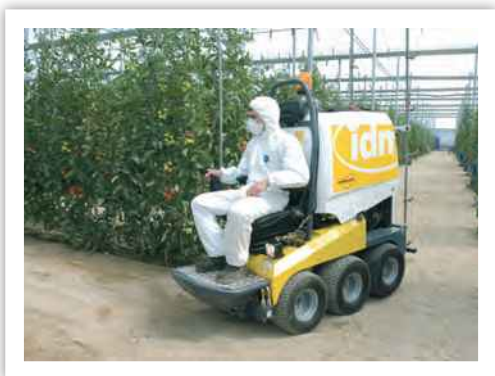
Carretilla autopropulsada, con las barras de tratamiento detrás del operador
