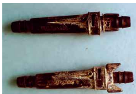
Goteros obstruidos por precipitaciones de cal
