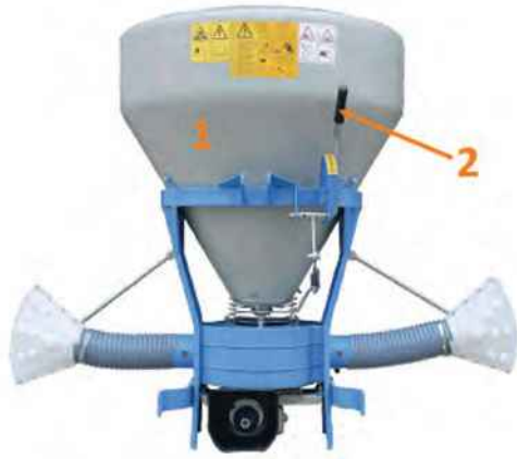
Limpiar bien el depósito (1) y el sistema de control de aplicación (2)
