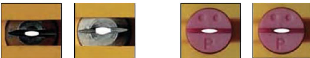
Boquilla de metal (izquierda) y cerámica (derecha). La primera foto es una boquilla nueva, la segunda una boquilla tras 50 horas de uso. La boquilla cerámica usada no se ha desgastado prácticamente.
