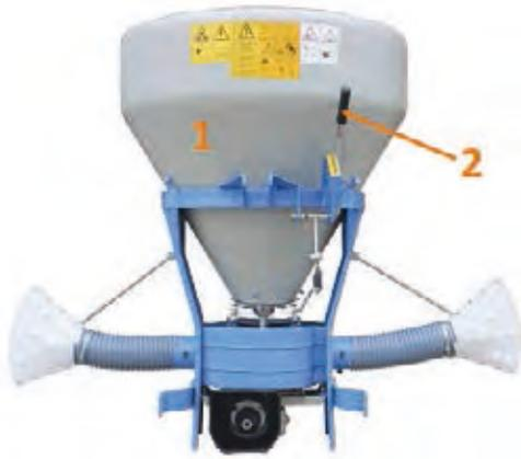
Limpiar bien el depósito (1) y el sistema de control de aplicación (2)
