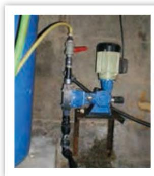
Equipos de inyección para aplicación de fitosanitarios en el riego localizado
