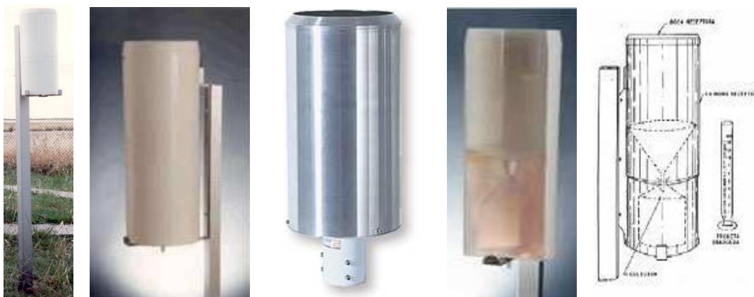
Pluviómetros Hellmann. Probeta de medida
