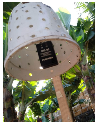
Foto 13.- Sensor de temperatura y humedad colocado en campo.
