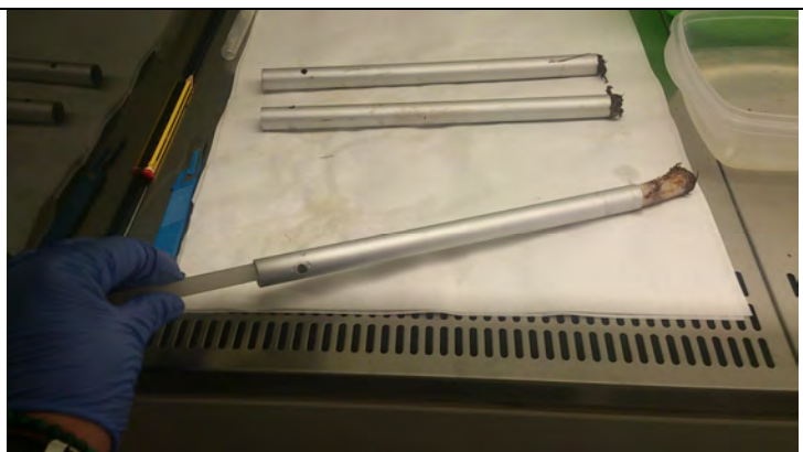
Foto 10.- Extracción en laboratorio de la muestra del sacabocado.
